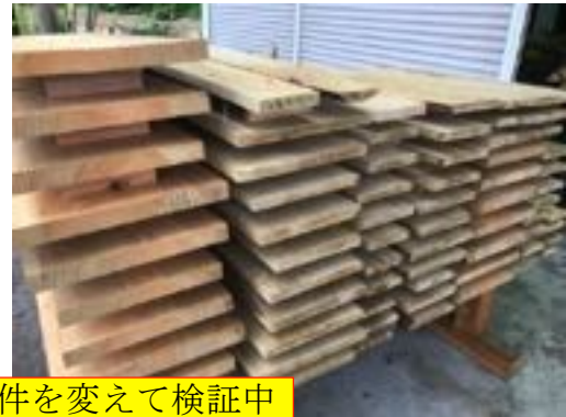
10mm-30mm厚の板材や輪切り材、直径100mm未満原木等貯木期間を変え、水も交換しながら検証
