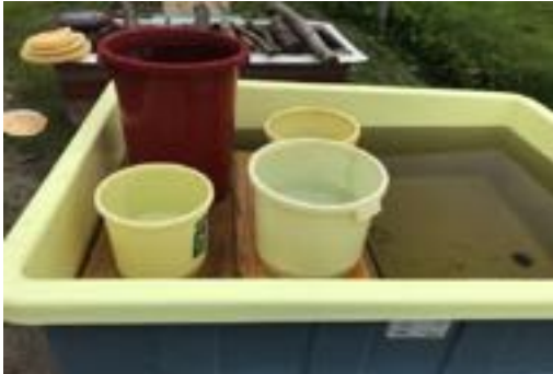
10mm-30mm厚の板材や輪切り材、直径100mm未満原木等貯木期間を変え、水も交換しながら検証
