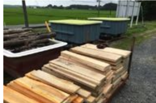
10mm-30mm厚の板材や輪切り材、直径100mm未満原木等貯木期間を変え、水も交換しながら検証
