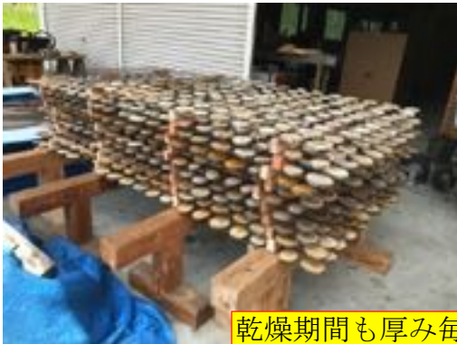
10mm-30mm厚の板材や輪切り材、直径100mm未満原木等貯木期間を変え、水も交換しながら検証
